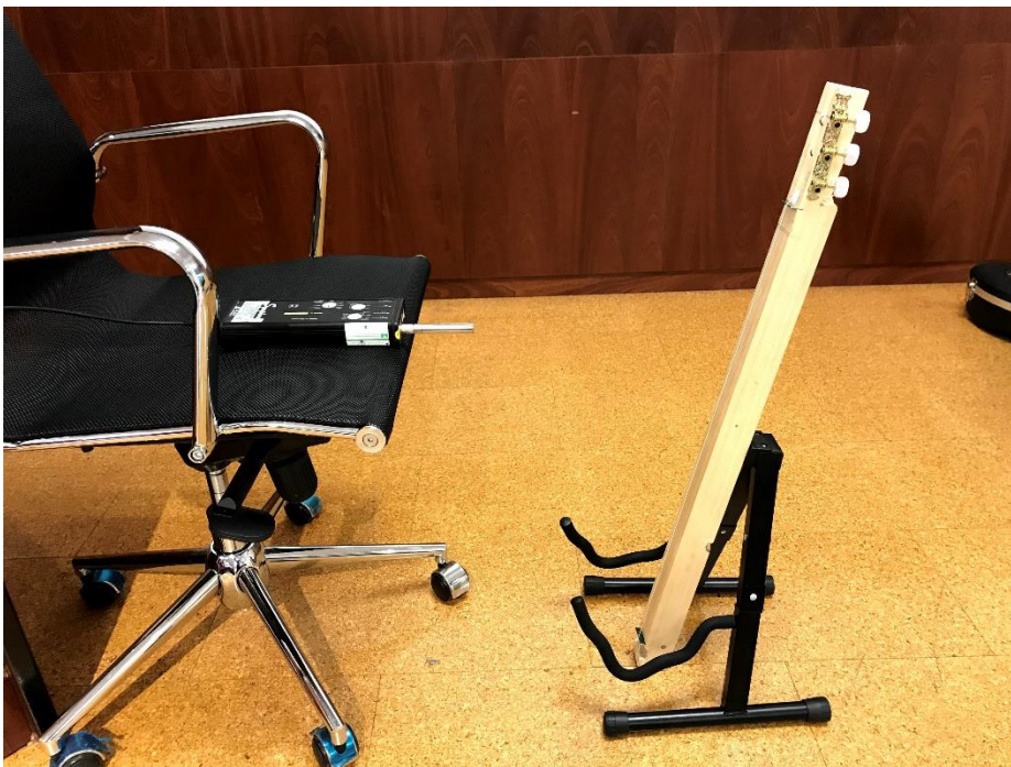
Figura 5-3. Disposición del ensayo de la cuerda exenta.
