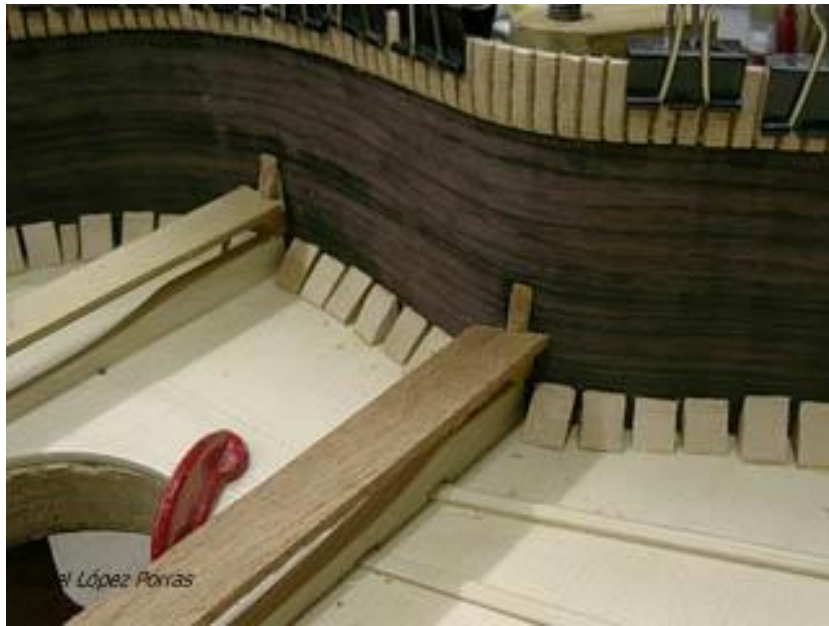
Figura 4-4. Detalle de unión de la tapa y el aro.
