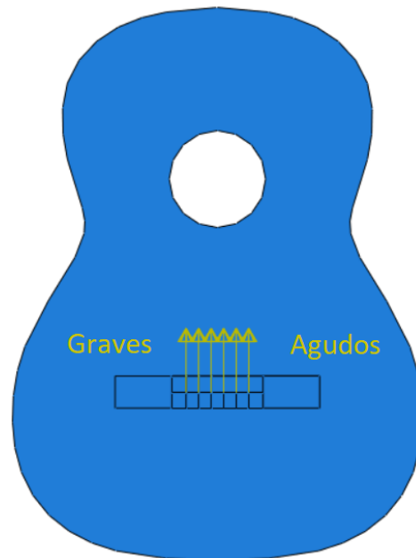
Figura 4-6. Esquema de fuerzas en el modelo para el caso estático.
