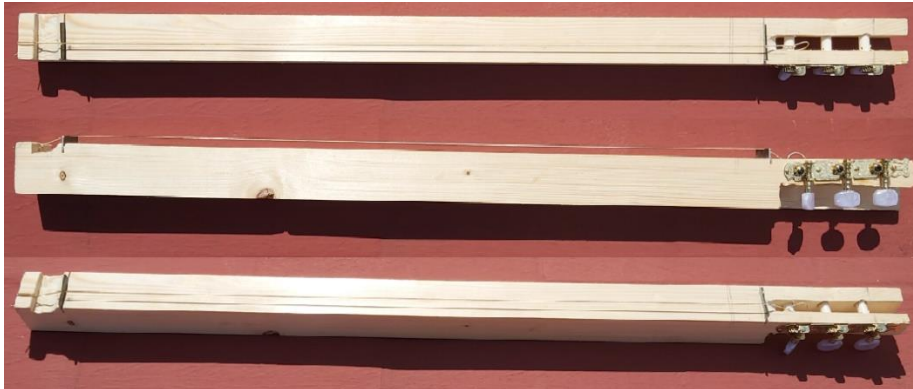
Figura 5-2. Instrumento para medir el sonido de la cuerda exenta.
