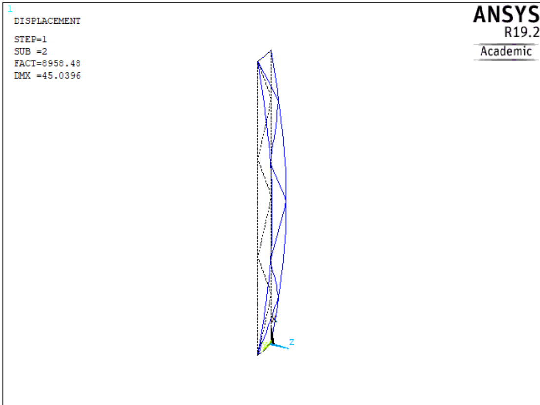
Figura 41. Primer modo de pandeo global del segundo caso para 3 módulos y h_0/L = 0.08 .
