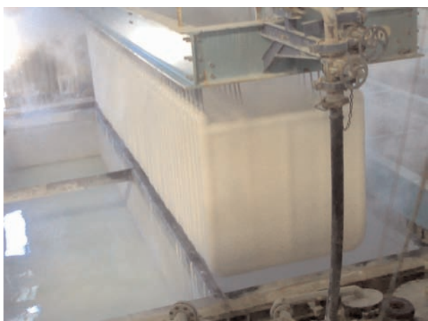
Figura 3.1. Sistema de filtración utilizado para la separación de la pulpa de \text{TiO}_2 . Se observan los filtros colmatados de pulpa de \text{TiO}_2
