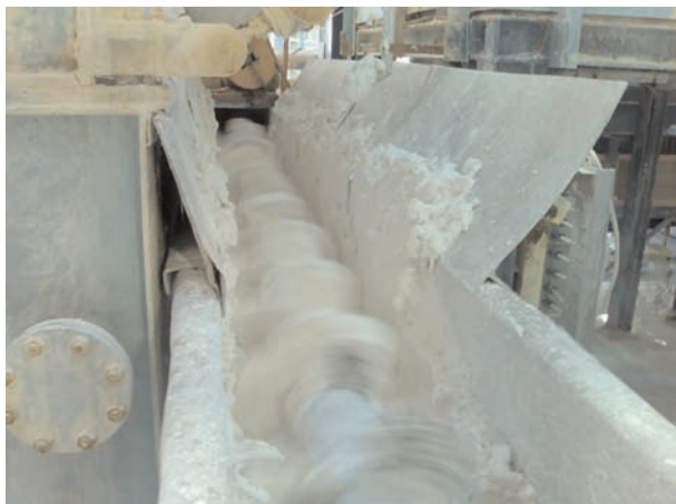
Figura 4.1. Pulpa de \text{TiO}_2 precipitada antes de ser sometida al proceso de secado y calcinación
