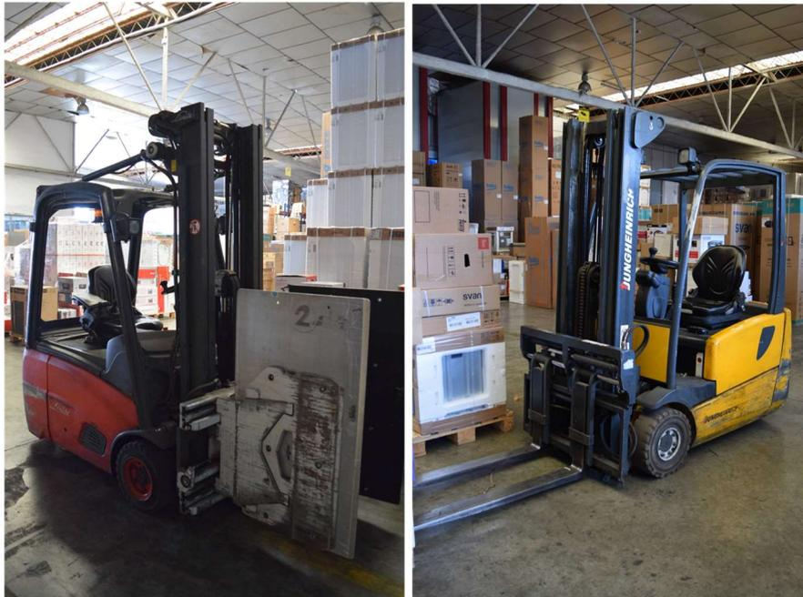
Figura 4-3. Carretilla contrapesada tipo pinza y carretilla tipo ña
