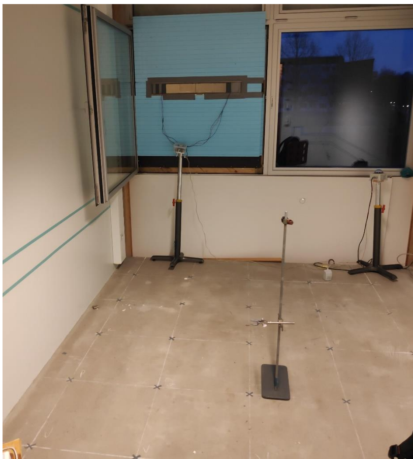
Figur 10. Till vänster visas enheten installerad i väggen. På golvet ses de markeringarna som visar var dragmätningarna genomfördes. I figuren till höger ses hur många mätningar som gjordes samt vad varje mätpunkt döptes till (A-Y).
