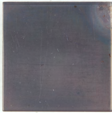
(a) Kupfercoupon mit oxidierter Oberfläche
