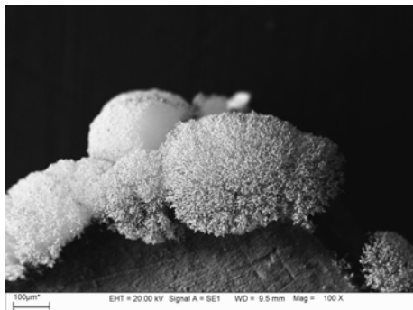
(a) büschelförmige Ausblühungen
