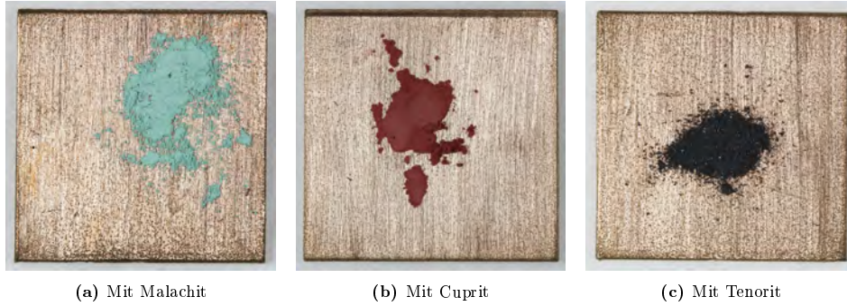
Abbildung 74: Geimpfte Kupfercoupons nach 30 W Exposition in Gegenwart von elementarem Schwefel bei 20 °C und 54 % rF
