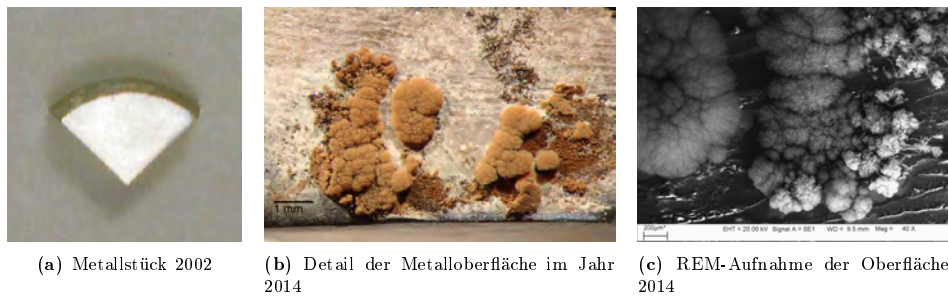
Abbildung 91: Korrodierte Metallprobe (Sn90Cu10) aus der Arbeit von Weichert (2002)
