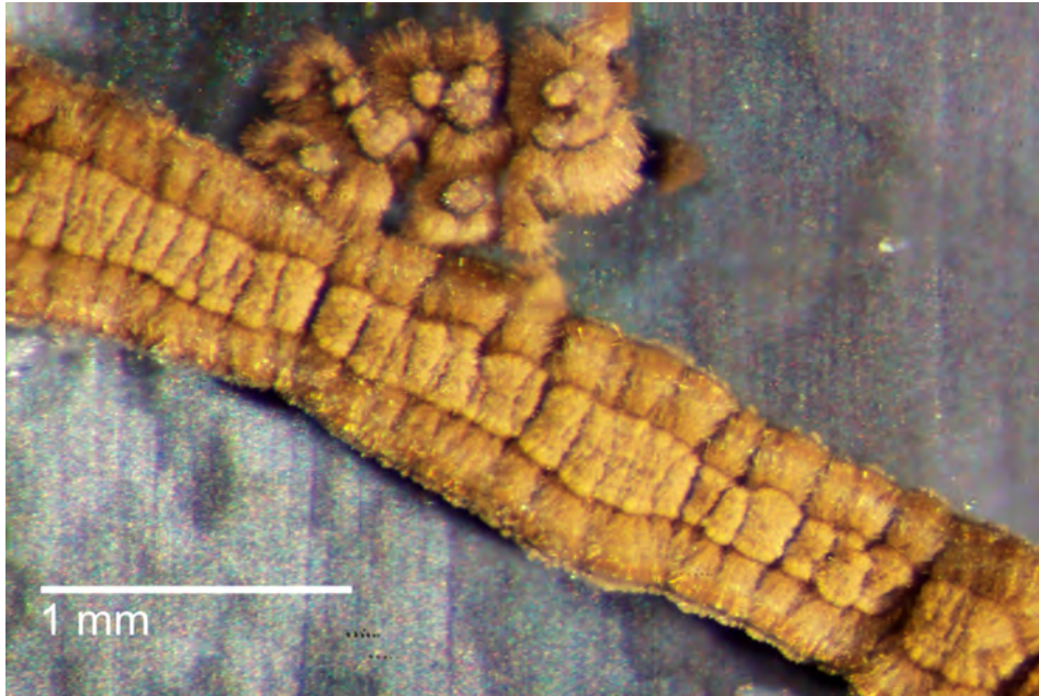
Abbildung 20: Unterseite vom Coupon gelöst, zu einer Reihe zusammengewachsener büschelförmiger Ausblühungen nach 30 W bei 40 °C und 95 % rF
