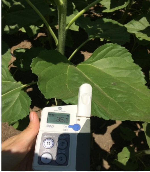
Şekil 3.10. SPAD-502 Plus ile yaprak azot içeriği ölçümü
