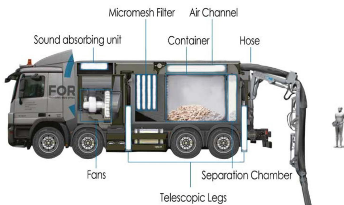
Kuva 16 – Kaivamiseen käytettävän suurtehoimurin osat (Force One)
