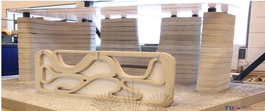
Figure 2.5 Printed concrete elements (Technische Universiteit Eindhoven, 2016).
