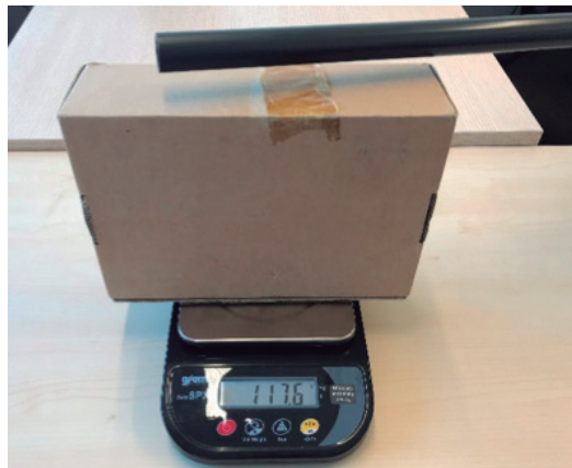
Imagen 2. Al acercar el tubo electrizado, la balanza marca menos. Está estirando de la caja hacia arriba, aunque no la mueva
