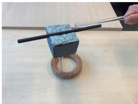
Imagen 3. El versorio permite detectar fuerzas atractivas y repulsivas con gran claridad. Puede colocarse la varilla electrizada sobre la base de porospán y acercarlo a objetos grandes o inmóviles
