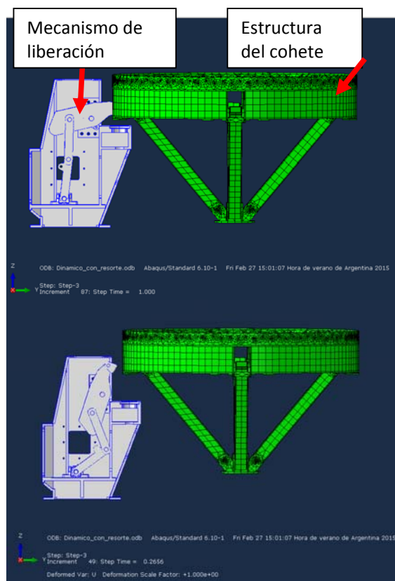
Figura 6. Vista esquemática de uno de los sistemas de liberación para realizar simulaciones
