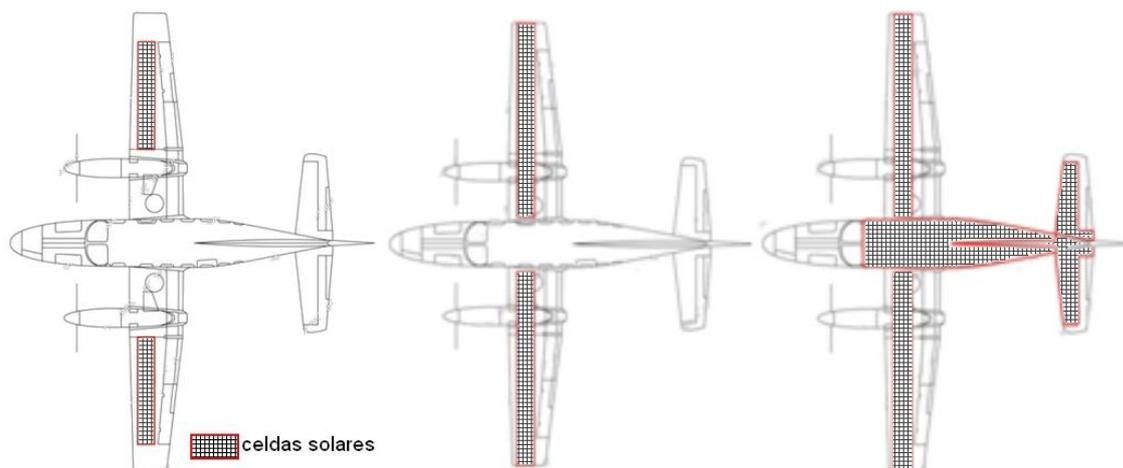
Figura 3: Disposición de celdas solares en la condición de vuelo de diseño. Fig. Izquierda: Configuración 1, Fig. Central: Configuración 2, Fig. Derecha: Configuración 3
