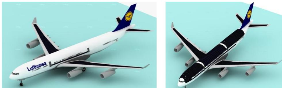
Figura 2: Disposición de celdas solares. Fig. Izquierda: Configuración 1, Fig. Derecha: Configuración 2
