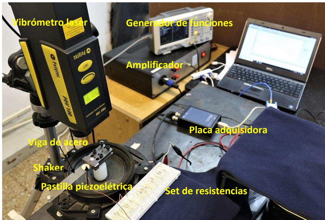
Figura 2: Diagrama esquemático del sistema estudiado
