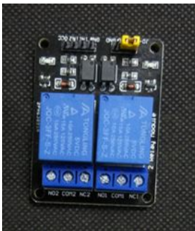
(a) Placa de Relés com Sinal 5V e 2 Canais 220V/10A
