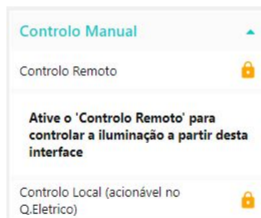
Figura 5.19: Ativação e desativação dos Controlos Manuais
