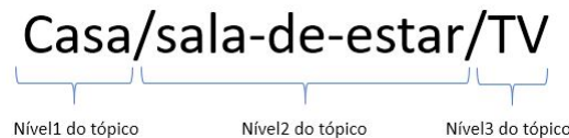
Figura 3.21: Exemplo de um tópico referente, ao controlo de uma televisão que se encontre na sala de estar de uma habitação
