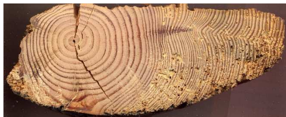
Billede 6: Tværsnit af tømmerstok fra Reistad, Vågen (Havly), gnr/bnr 17/17, våningshus. Prøven, som er taget i form af en skive, er gjort klar til årringsmåling ved hjælp af slibning. Den højre del af prøven, med små huller efter insekter, er splintveddet. Prøven indeholder 60 årringe, og dækker tidsrummet 1693 til 1752. Scan: Nationalmuseet.
