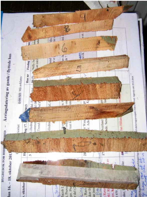
Billede 8: Prøver udtaget i form af trekanter fra Nedre Veisdal, Odden (Langenes), gnr/bnr 25/38 og 40, i våningshuset fra væggen mellem entré og spisestue. Tømmeret daterer til efter 1866. Foto: Claudia Baittinger.
