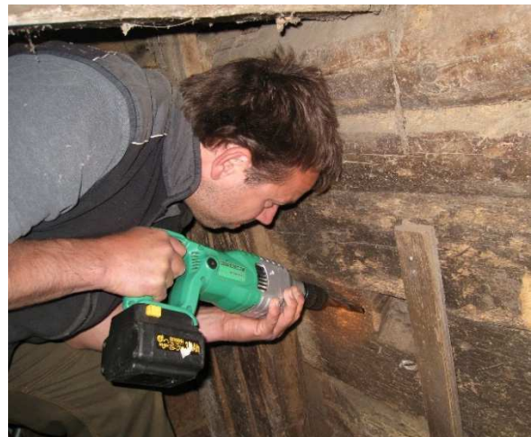
Billede 10: Løe fra Ysthus, gnr/bnr 9/3. Christoffer Christensen tager en boreprøve af et stykke genanvendt tømmer. Se også dateringsdiagram i figur 5. Foto: Inger Vågen.
