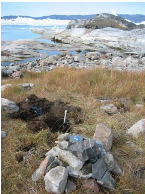
Figur 23: Varde med temperatursensorer. Bagved ses hvor sensorerne føres ned i jorden (hullet er siden blevet tildækket).
