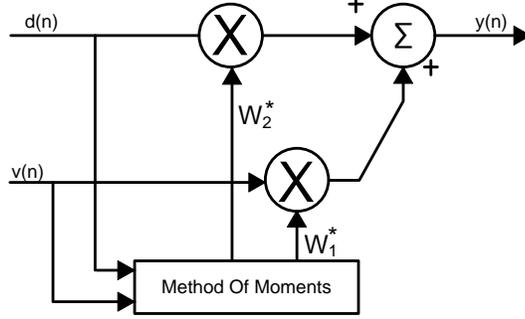
**Fig. 54: Dual-Tap IQI Compensation Method**
