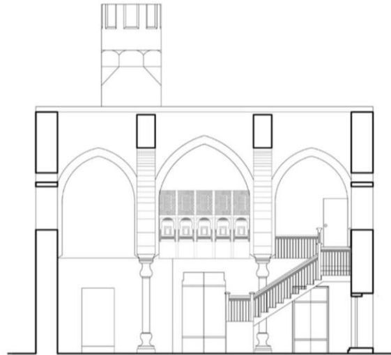
Section of Mezzanine قطاع يوضح الدور المسروق
