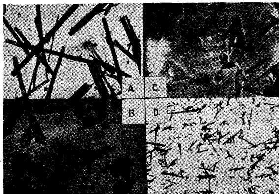
Figure 2—Polymorphic forms of HMX : (A) \alpha - HMX ; (B) \beta - HMX ; (C) \gamma - HMX and (D) \delta - HMX .
