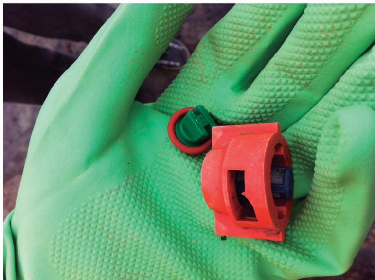
*Figura 2: Verificando o estado dos filtros e pontas de pulverização.*
