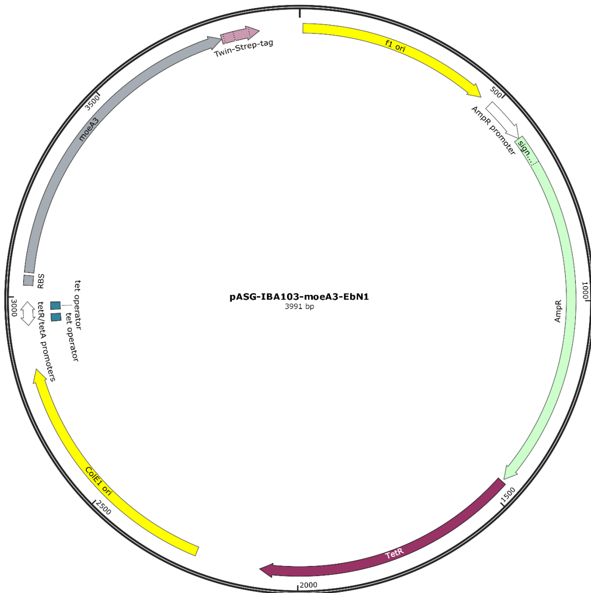
Abbildung 36: Plasmidkarte von pASG-IBA103- moeA3 -EbN1. Auf diesem Plasmid ist das Gen moeA3 ( ebA4355 ) kodiert. Das Gen ist am 3'-Ende mit einem Twin-Strep-Tag fusioniert. Die Gensequenz steht unter Kontrolle eines Tetrazyklin-Promoters ( tetR/tetA ). Der Replikationsursprung ist ein ColE1-Origin . Als Selektionsmarker dient eine Ampicillin-Resistenz ( AmpR ).
