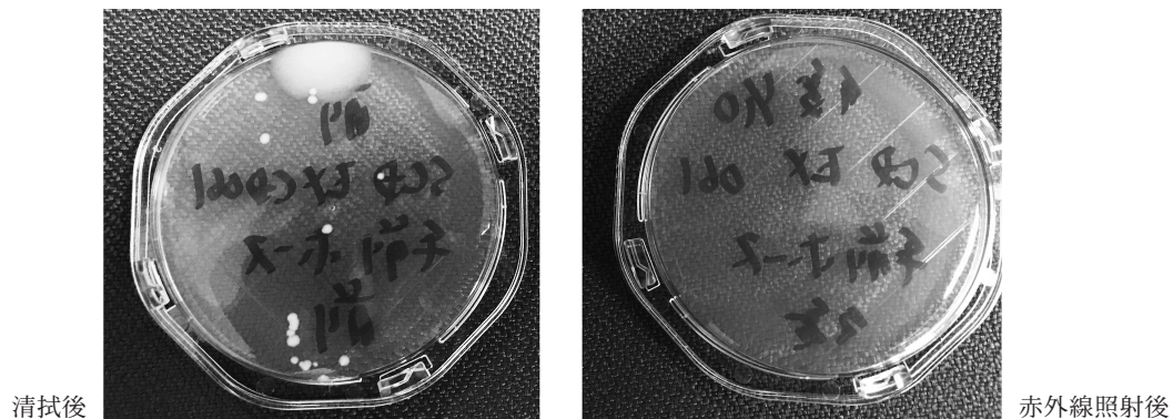
図2 各プレート培地に発育した細菌集落 コンタクトプレート用手清拭後、紫外線照射後は微生物検査室内のインキュベータで35℃に培地表面を上にして約20時間培養した後、コロニー数を目視にて数えた。 例として、写真の清拭後のコロニー数は15個、照射後は0個。
