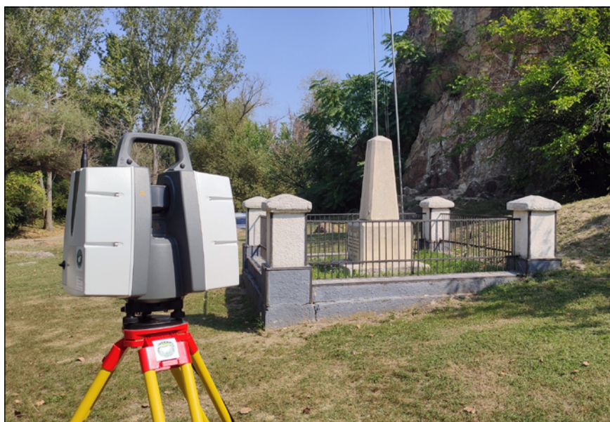
2. ábra. Leica P40 lézerszkennerek az obeliszkek előterében
