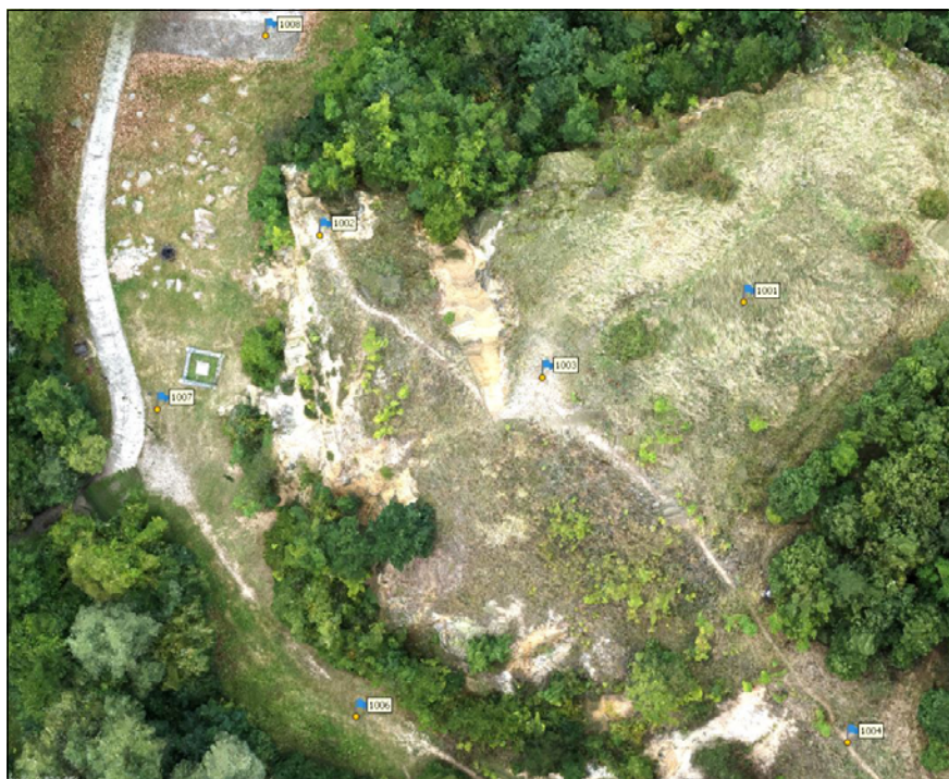
5. ábra. UAV illesztőpontok a sziklafal megközelíthető részein
