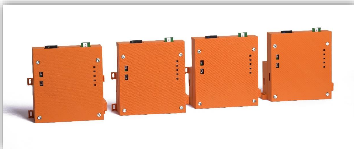
Slika 8.1: končni izdelek – napajalni in krmilni moduli v ohišju
