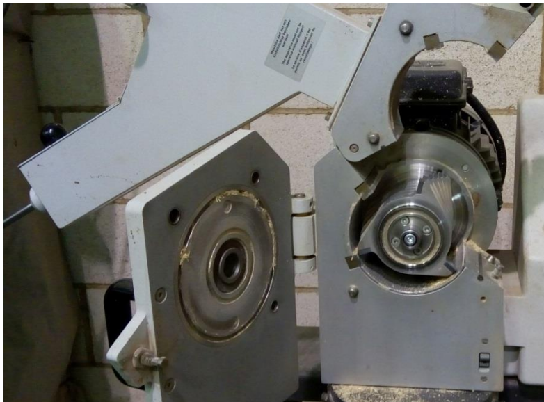
Figura 3.8. Molino de impacto para reducir el tamaño de partícula de una muestra.
