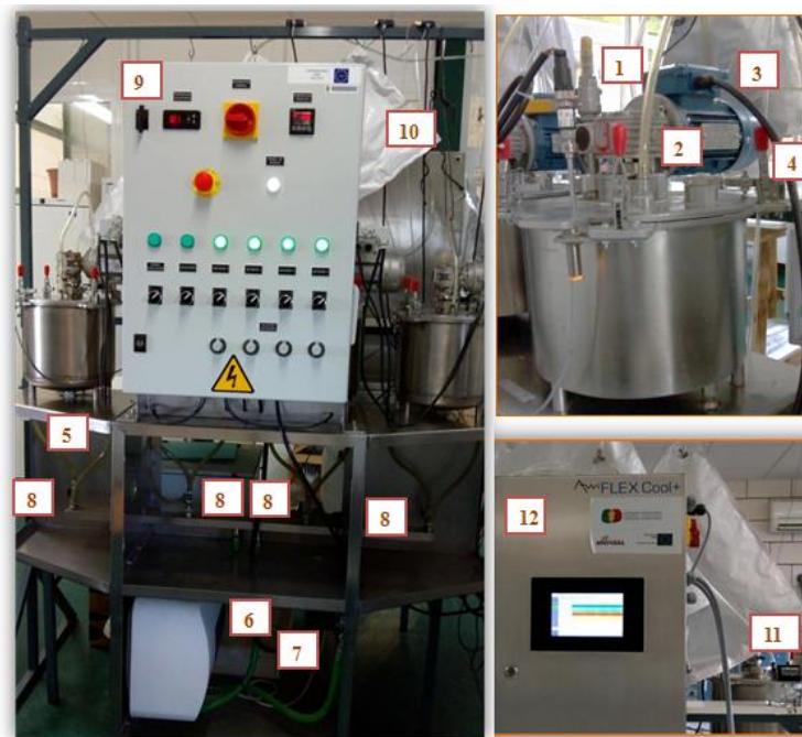
Figura 4.12. Equipos de digestión anaerobia, medidores y montaje experimental de biogás producido empleados en experimentos realizados de digestión anaerobia.
