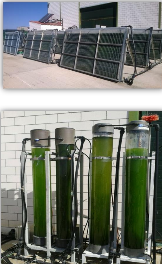
Figura 4.8. Columnas y paneles correspondientes a la planta piloto de microalgas.
