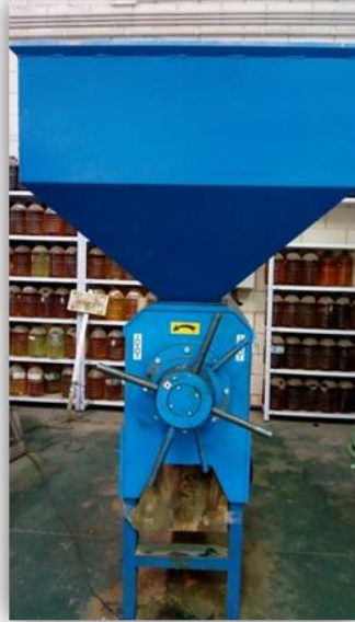
Figura 4.5. Prensa Farmet® CESKA SKALICE FL200 LCPV7-11 usada en el proceso de extracción de aceite de las semillas de colza.
