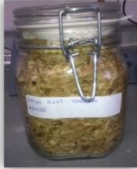
Figura 4.3. Silos de pequeño tamaño con material vegetal lignocelulósico para emplear como sustrato en digestores anaerobios.
