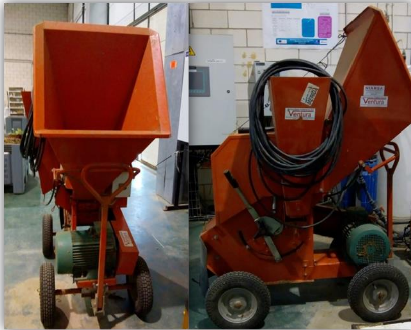
Figura 4.2. Trituradora Niarsa utilizada en el primer pretratamiento de tipo mecánico en sustratos de origen vegetal.
