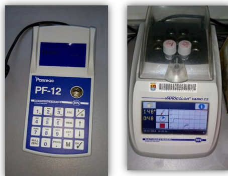
Figura 4.15. Fotómetro PF-12 Macherey Nagel para la medición de DQO y nitrógeno amoniacal en muestras de sustratos y digestor Vario C2 NANOCOLOR ® Macherey Nagel para la digestión previa.
