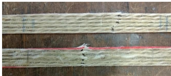
Figura 56. Padrão de rompimento observado nas fibras de sisal.
