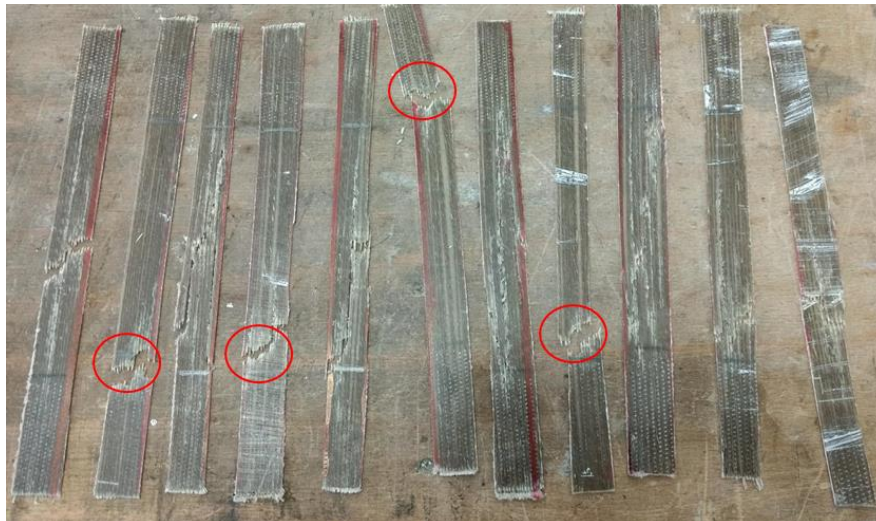
Figura 57. Os 11 ensaios realizados com destaque para os resultados inválidos por romper próximo a garra do equipamento.
