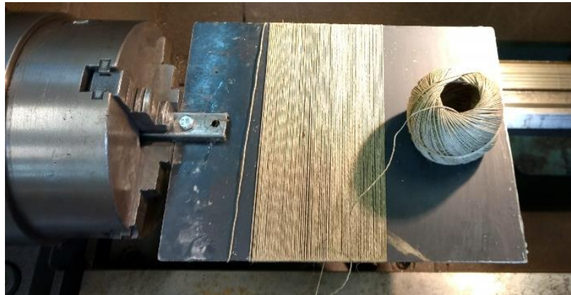
Figura 41. Alinhamento de fio do norte utilizando torno mecânico.
