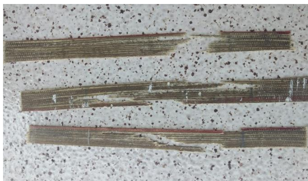
Figura 58. Padrão de rompimento do compósito de epóxi/linho (fio do norte).
