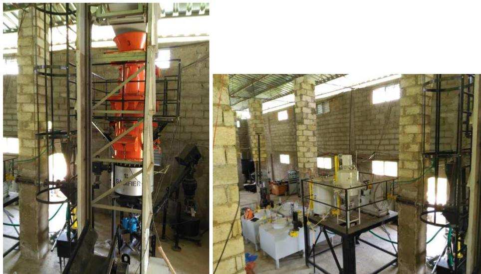
Figura 6.3. Gasificador (izquierda) y sistema de depuración y acondicionamiento del gas (derecha)
