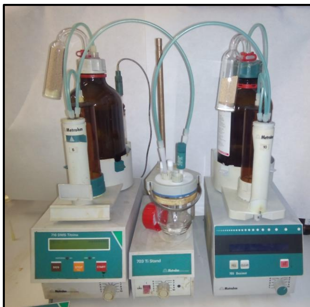
Figure 3.5. 716 DMS titrino and 665 Dosimat for Karl Fischer titration.
