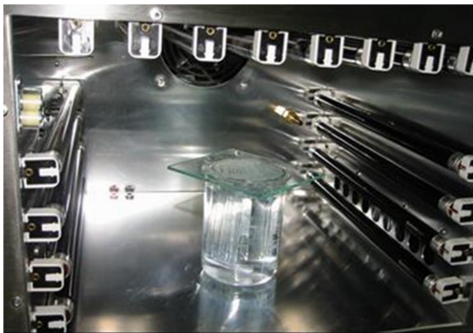
Figura 61. Fotografia del foto-reactor amb el muntatge descrit en l'apartat 3.4.2 per a la destrucció de blau de metilè.
