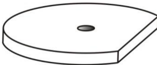
Figura 25 Esquema d'un disc d'acer tallat de tal forma que permet el pas de gas per un dels seus costats.
