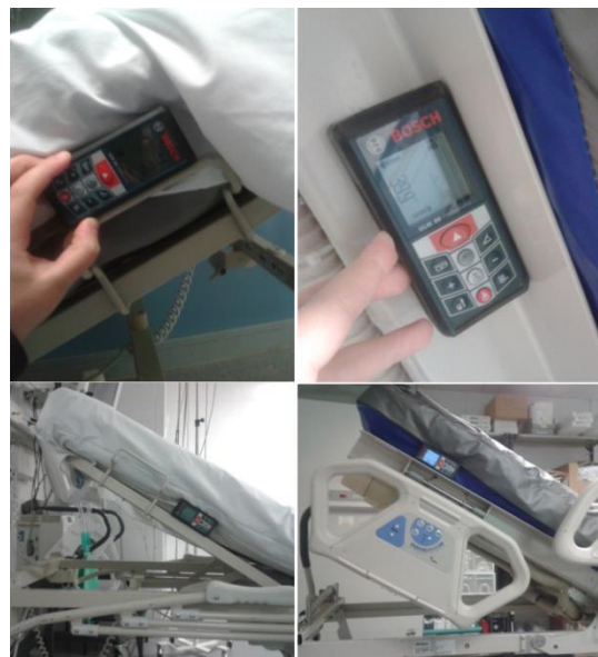
Figura 6. Ejemplos del procedimiento para realizar la medición de la inclinación del cabezal
