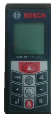
Figura 5. Dispositivo BOSCH GLM 80® para realizar las mediciones
