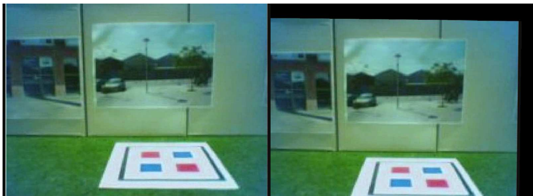
Figura 2.19. Reconstrucción de la imagen original a partir de la imagen deformada y de la matriz de homografía estimada.
