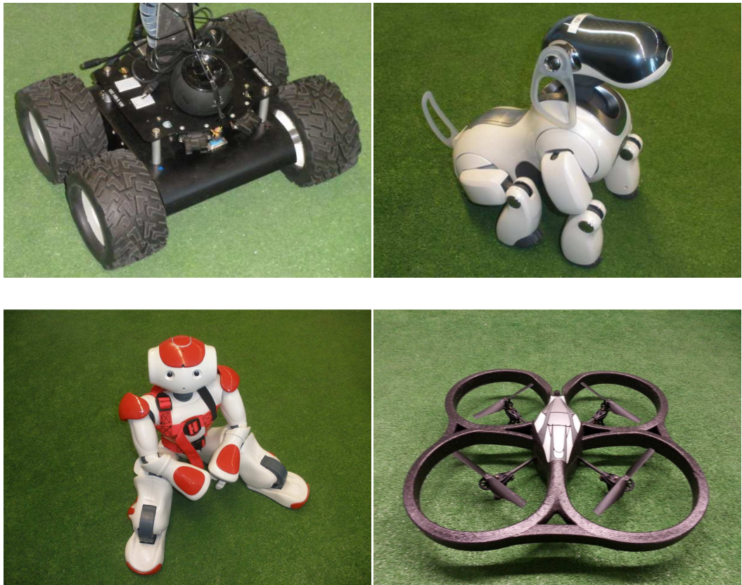
Figura 1.1: Ejemplos de plataformas robóticas. Robot con ruedas: Wifibot (Izquierda superior). Robot cuadrúpedo: Aibo ERS 7 (Derecha superior). Robot bípedo: Nao (Izquierda inferior). Robot Aéreo: AR.Drone (Derecha inferior).
