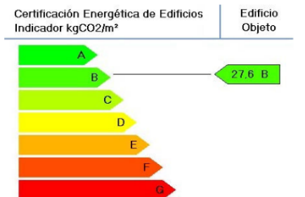
Fig. 19 Taules resum dels resultats de la simulació d'Eficiència Energètica amb el programa CALENER VYP d'un edifici escolar. Font: (Gilberte, et al., 2012)
