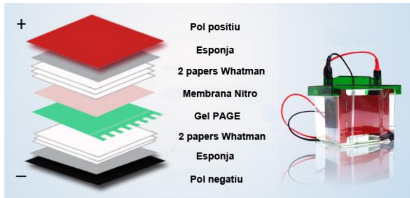
Figura 53. Transferència proteica. Esquema representatiu de muntatge dels gels i les membranes de nitrocel·lulosa previ al procés de transferència proteica amb el Miniprotean Kit de Bio-Rad.
