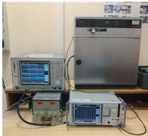
Fig. 3. 18. Montaje experimental para caracterizar y modelizar el impacto de la temperatura en las emisiones conducidas
