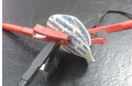
FIGURA 10. Configuración de electrodos para medir la impedancia intrínseca con un analizador de impedancia a 50 kHz de fase sensible. Clips negros inyectan corriente (I) y clips rojos miden voltaje (V).
