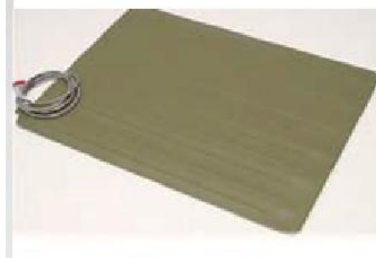
Fig. 31: Processador de senyals Chronopic Fig. 32: Plataforma de contactes rígida formada per dues làmines de fibra de vidre Font: De Blas X.(2012).
