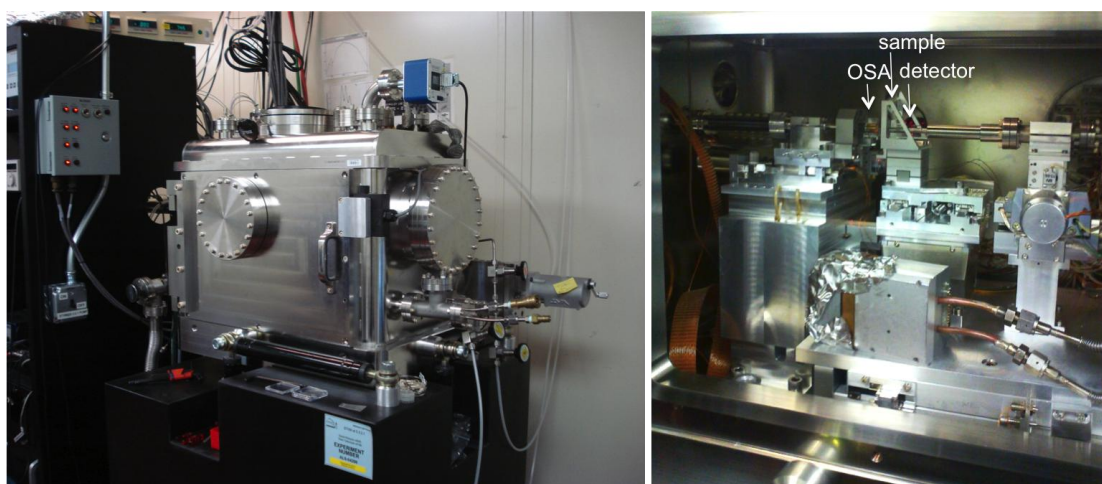
Figure 24 STXM at ALS beamline 5.3.2.1, external and internal view.
