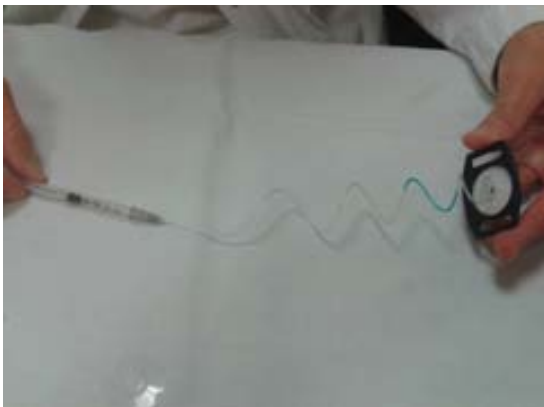
Figura 24. Amb una xeringa, s'aspira microtub de lectura
