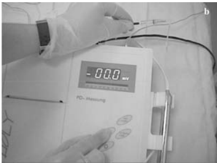
Figura 32 . Tholy: voltímetre de mesura de la DPN dissenyat per Lindemann.
