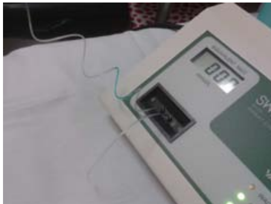
Figura 25. Col·locació del microtub a per omplir el l'aparell de lectura
