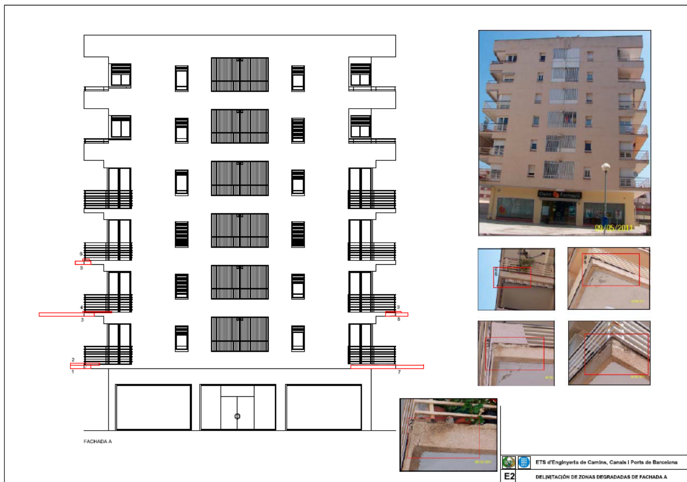
Figura IV.15. Caso real 5. Delimitación de zonas degradadas de la fachada A
