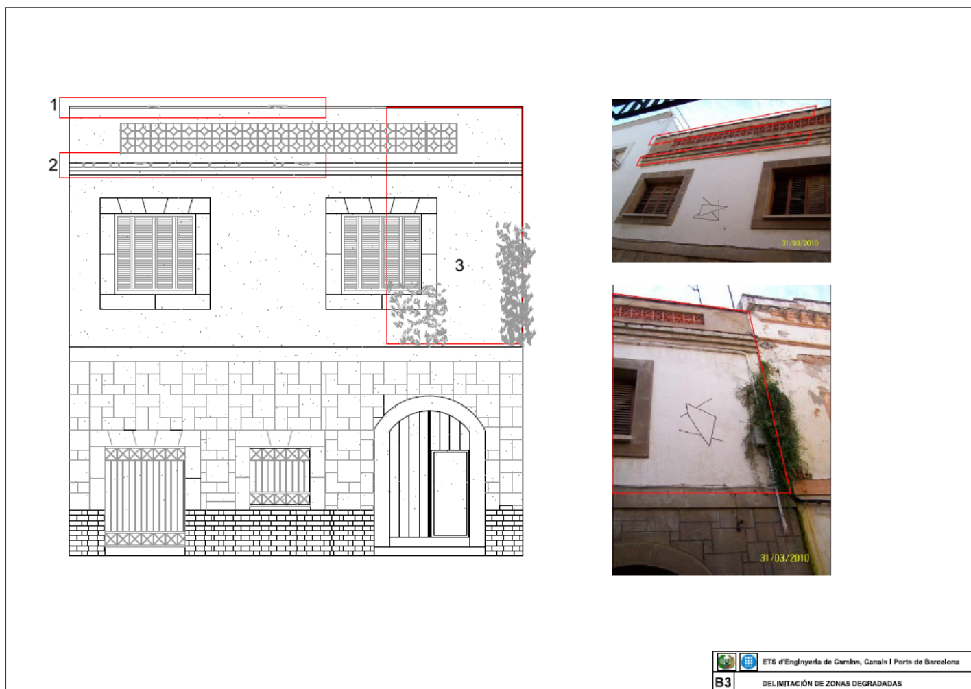
Figura IV.6. Caso real 2. Delimitación de zonas degradadas
