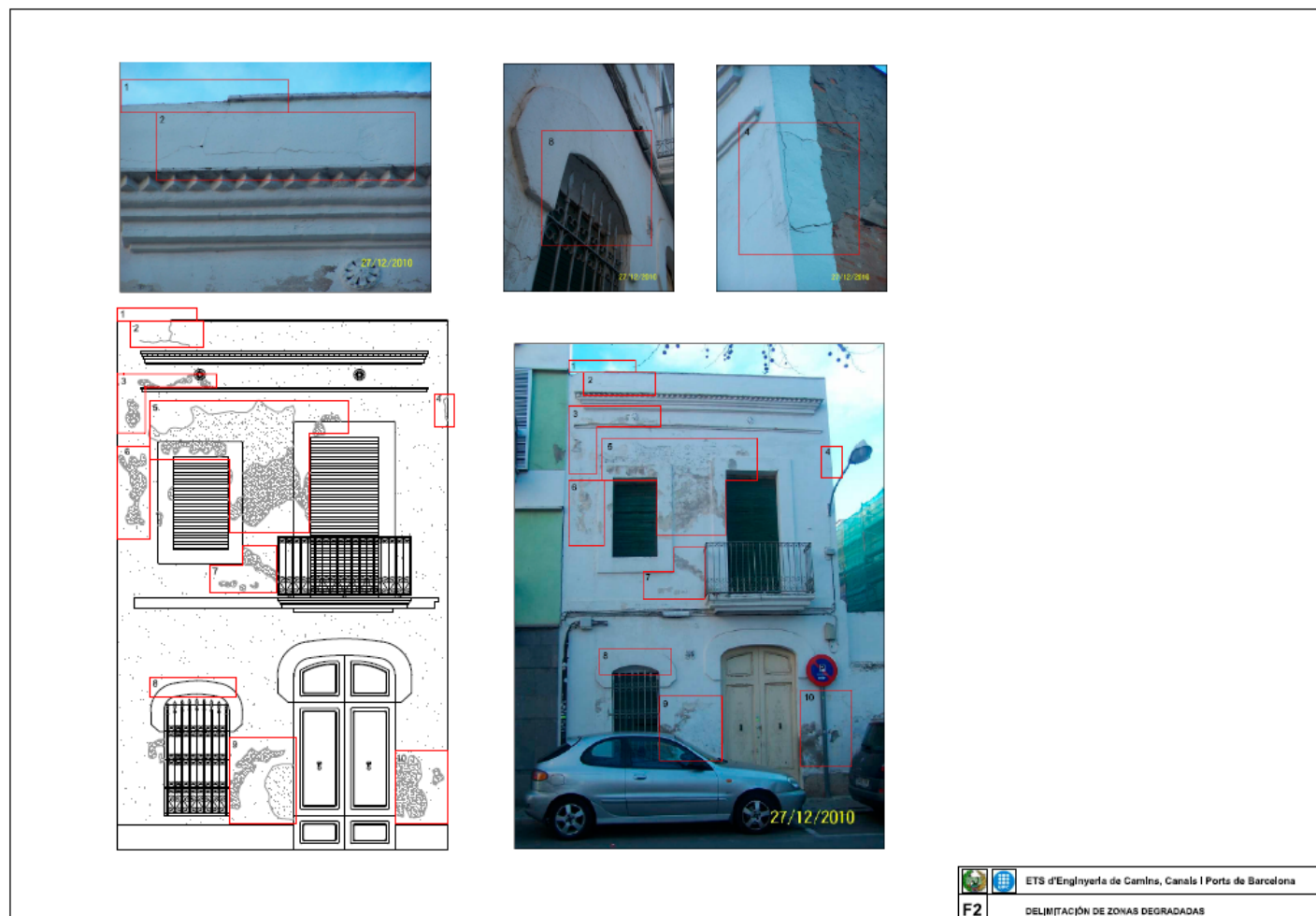
Figura IV.21. Caso real 6. Delimitación de zonas degradadas
