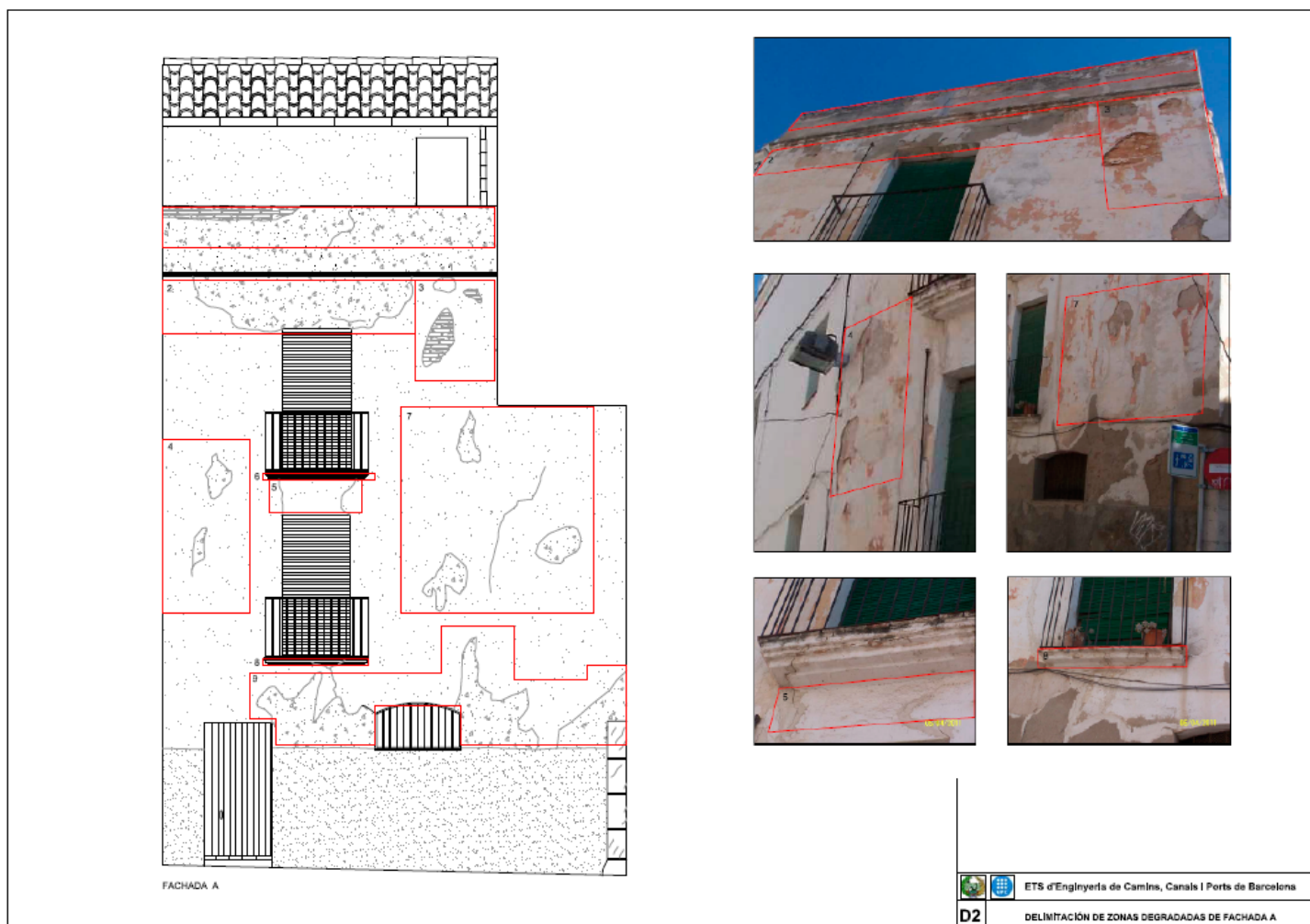
Figura IV.11. Caso real 4. Delimitación de zonas degradadas de la fachada A
