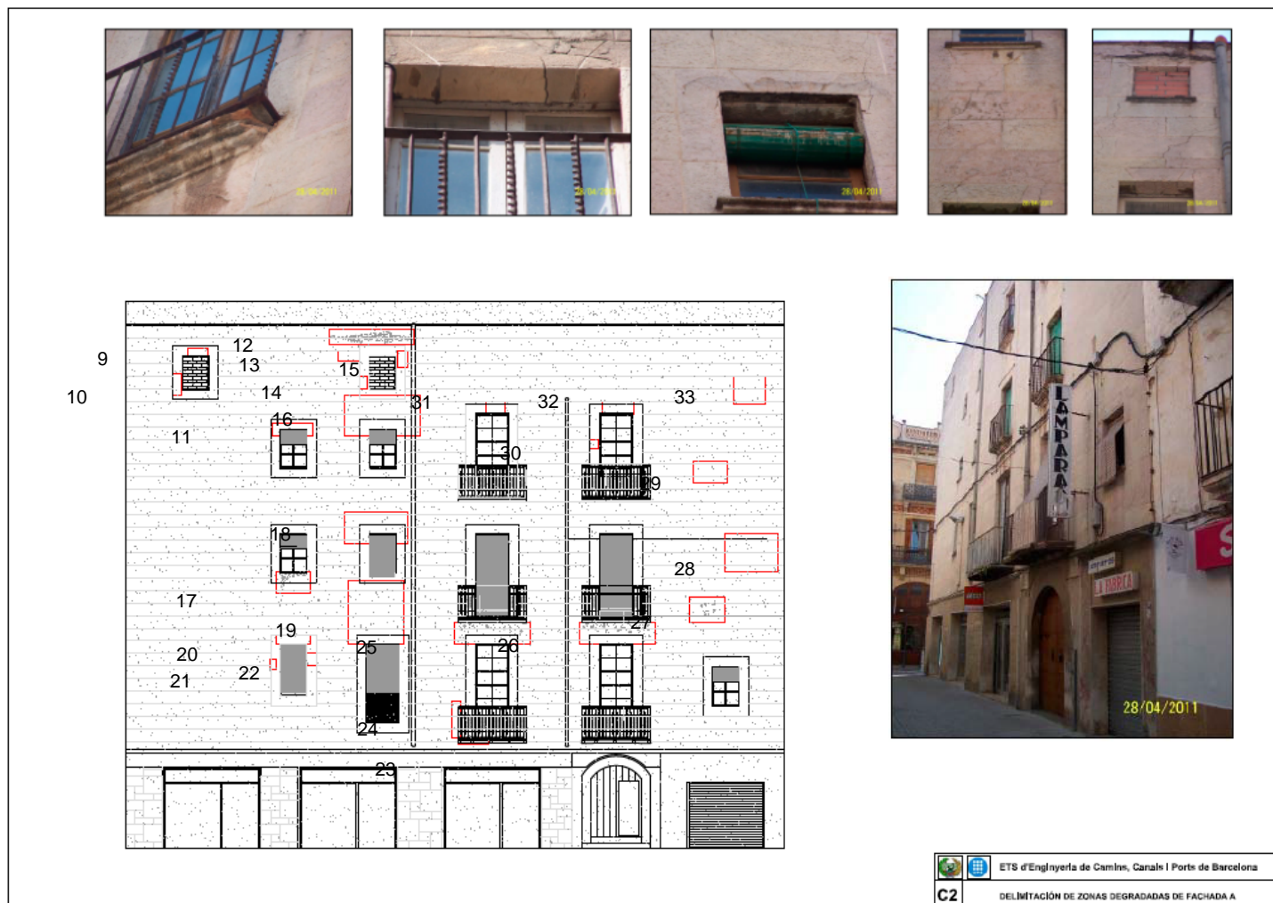
Figura IV.8. Caso real 3. Delimitación de zonas degradadas de la fachada A
