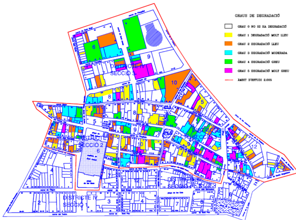
Figura 2.3. Distribución del grado de degradación del núcleo antiguo de Vilanova i la Geltrú
