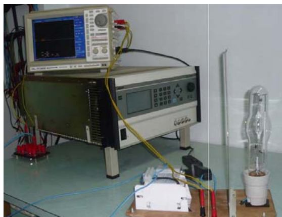
Figura 30. Ensayo sobre una lámpara de descarga de alta intensidad HPS de 400 W con una fuente de tensión AC ELGAR Smart-wave 4.5 kVA y un osciloscopio digital YOKOGAWA DL 780E.
