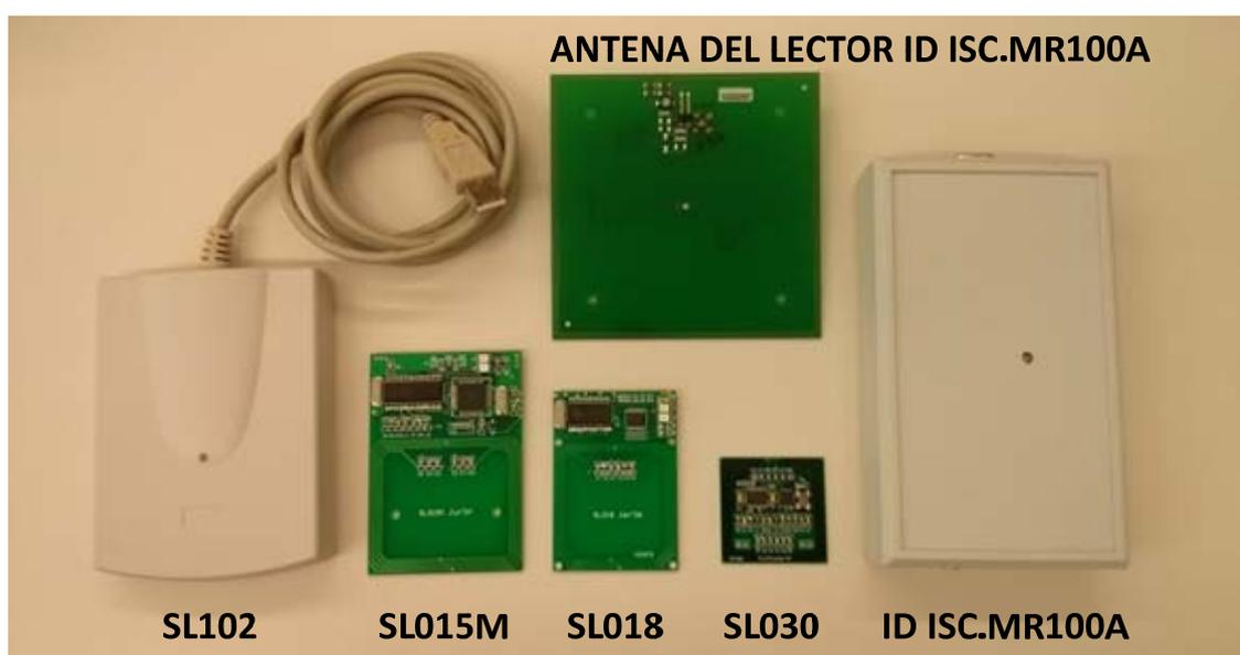
**Figura 3.1** Lectores RFID utilizados para el estudio.
