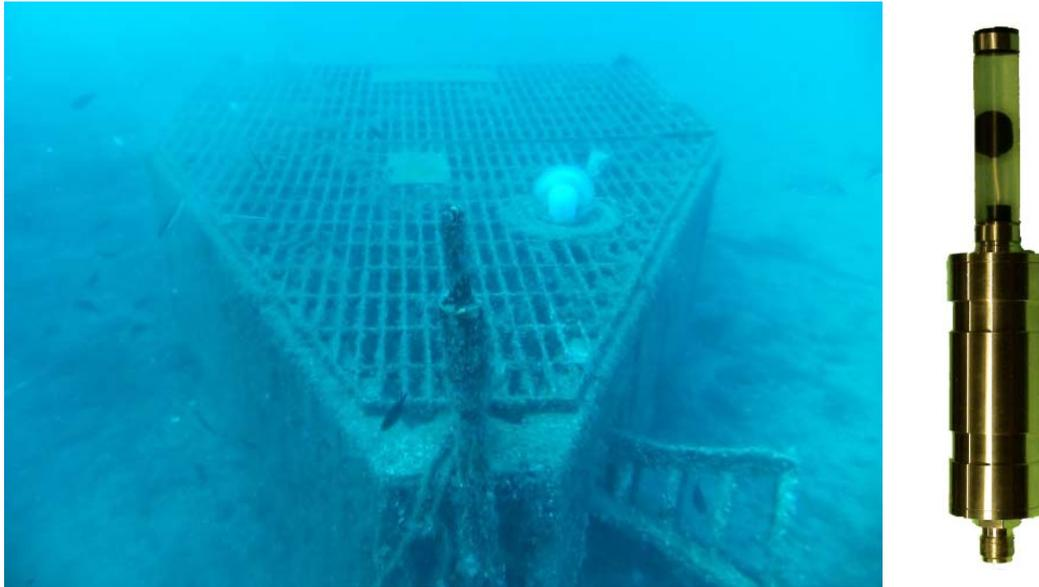
**Figura 4.41** Observatorio submarino OBSEA y su hidrófono cableado Naxys.
