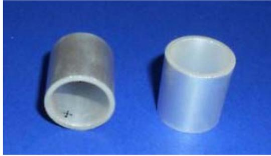
**Figura 4.20** Cilindro piezoeléctrico utilizado como transductor acústico sumergible.
