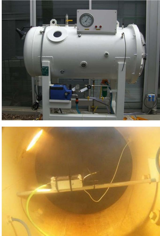
**Figura 4.40** Evaluación del prototipo en la cámara hiperbárica a 2 bares de presión.
