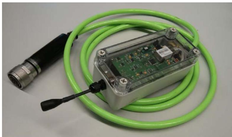
**Figura 4.39** Adaptación del prototipo para su operación bajo el mar.
