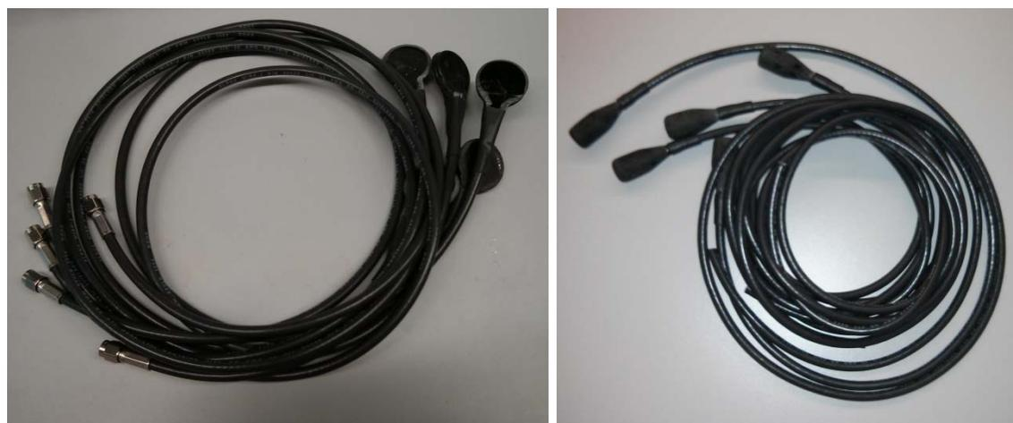
**Figura 4.25** Transductores construidos. Con discos piezoeléctricos a la izquierda; con cilindros piezoeléctricos a la derecha.
