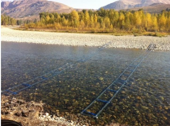
**Figura 1.9** Dos arrays de antenas para la detección de peces marcados con PITs en el río Methow en Washington.
