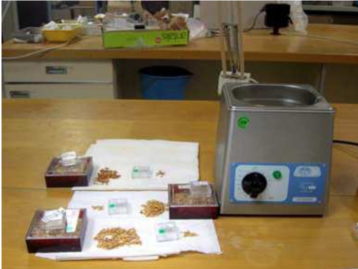
Figura 2.8. Lavado de muestras con cubeta de ultrasonidos en la Univesidad de Zaragoza
