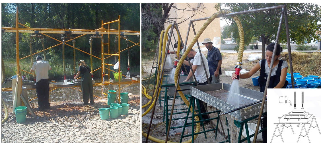
Figura 2.3. Esquema del montaje de tamices en torre. Izquierda: Estructura utilizada para el lavado-tamizado en Atapuerca (ideada por Gloria Cuenca-Bescós). Derecha: Estructuras utilizadas para el lavado-tamizado en los yacimientos de Orce y esquema del sistema de lavado con torre de tamices.
