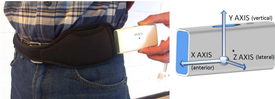
Figura 6.2. Orientación de los ejes del acelerómetro en la posición anterior-lateral
