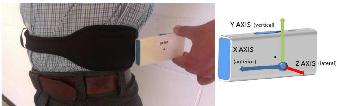
Figura 3.1. El sensor 9x2 y su diseño específico con el cinturón de neopreno
