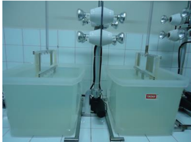
Figura 18: Robo utilizado nos ensaios acelerados de corrosão das placas pintadas.
