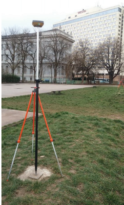
Slika 4.2. Topcon HiPer SR tijekom opažanja
