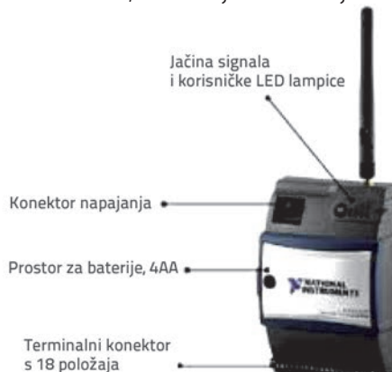
Slika 2. Tipični mjerni čvor bežične senzorske mreže
