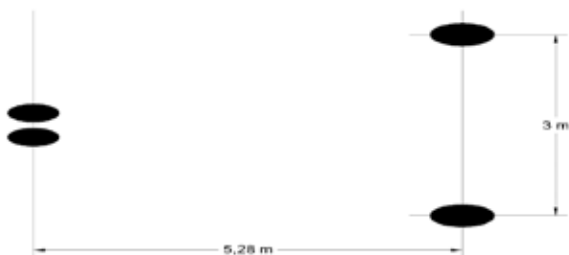
Slika 7. Raspored opterećenja na kotače helikoptera
