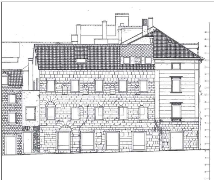
Slika 4. Zidno platno romaničke palače na istočnom dijelu sklopa hotela Central (crtež: S. Buble, na snimci stanja 1978. godine iz arhiva KO Split)
