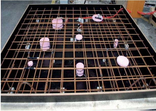
Slika 1 Eksperimentalni poligon, s različitim simuliranim oštećenjima prije ugradnje betona
