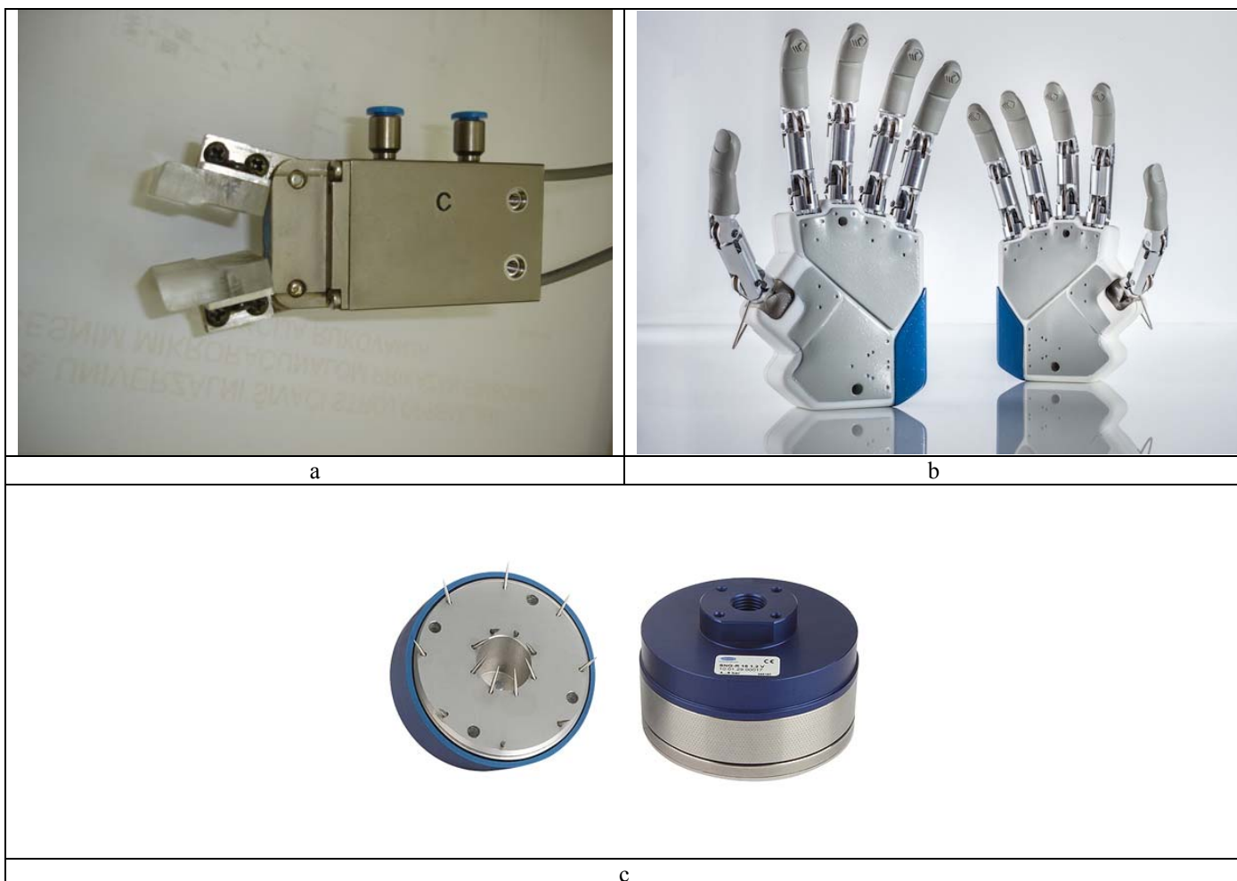
Slika 1. Mehaničke hvataljke: a) mehanička kliješta, b) mehanički prsti, c) hvatanje s iglicama
