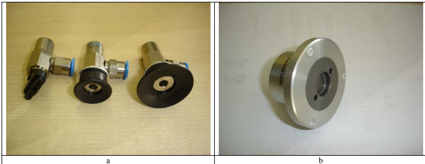
Slika 2. Pneumatske hvataljke: a) vakuumske hvataljke, b) Bernoulijeva hvataljka
